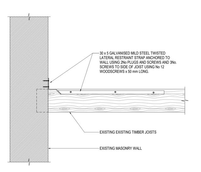
RESTRAINT TO EXISTING WALL PARALLEL TO JOISTS
