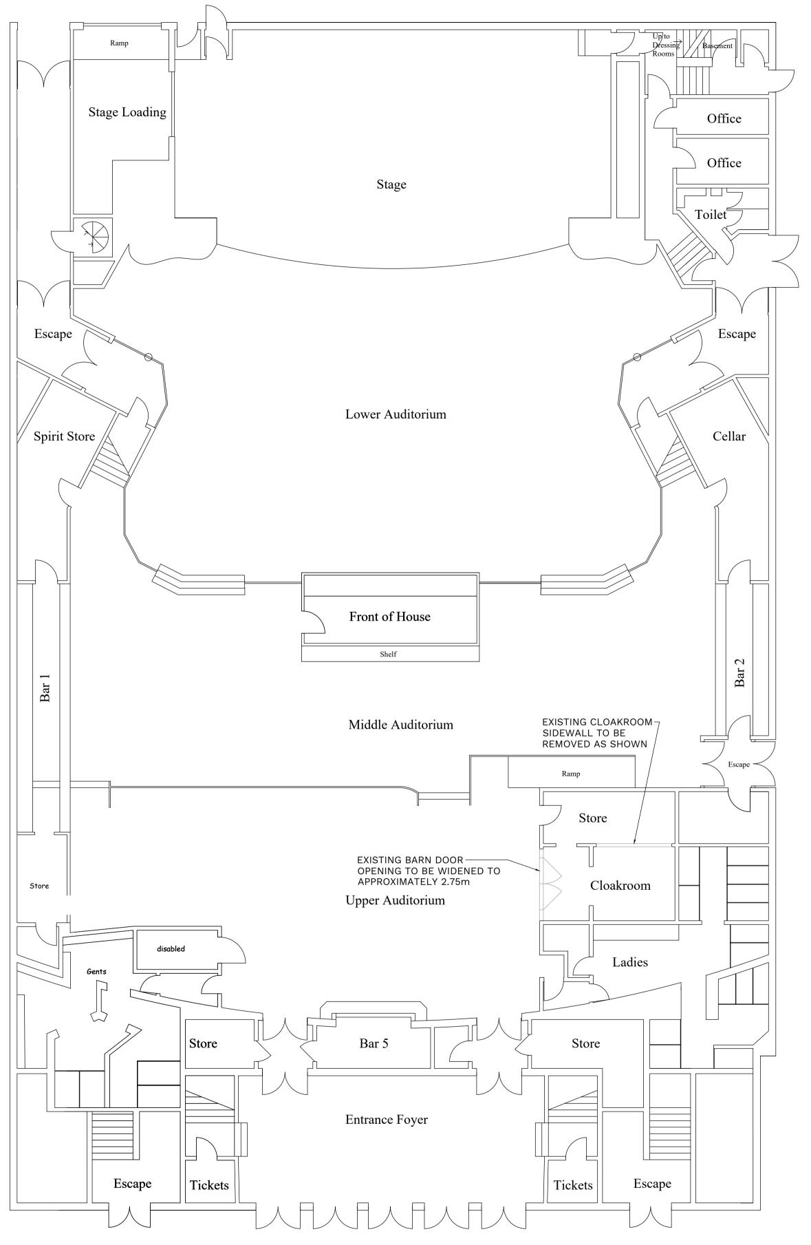
EXISTING GROUND FLOOR PLAN **SCALE 1:100 AT A1**
