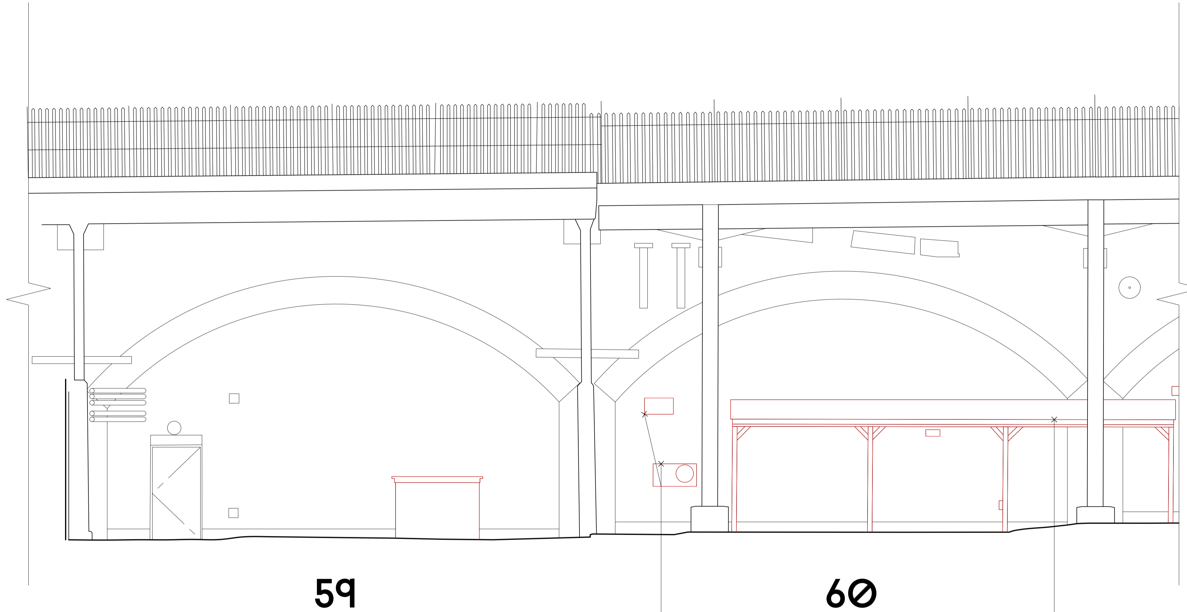
1 Existing Elevation - Arches 59 - 60 Scale: 1:50
