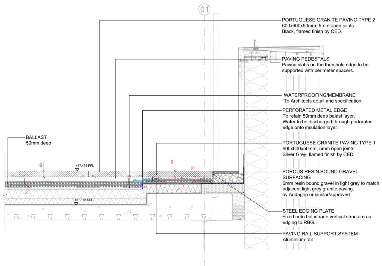
TYPICAL SECTION B-B: PAVING & CLADDING
