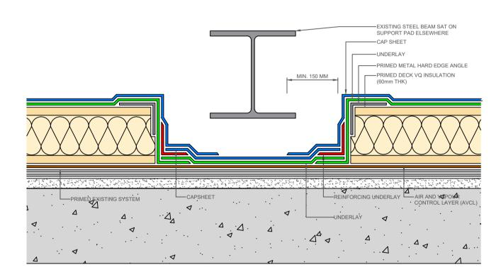
D: PROPOSED INSULATED GUTTER UNDER SIDE OF STEEL BEAM
