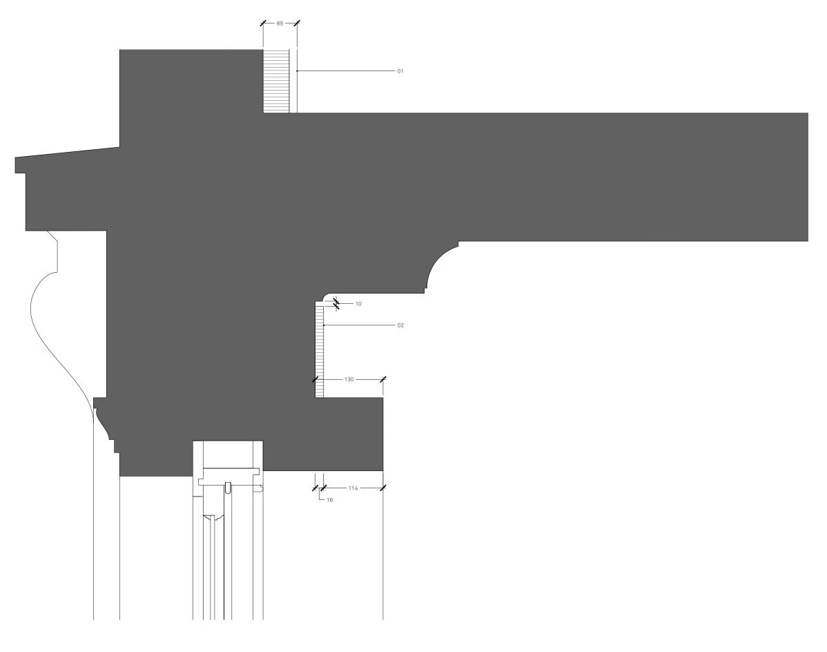
60MM WOODWOOL INSULATION WITH LIME PLASTER PROVIDING BREATHABLE INSULATION IN 1970'S MANSARD EXTENSION
