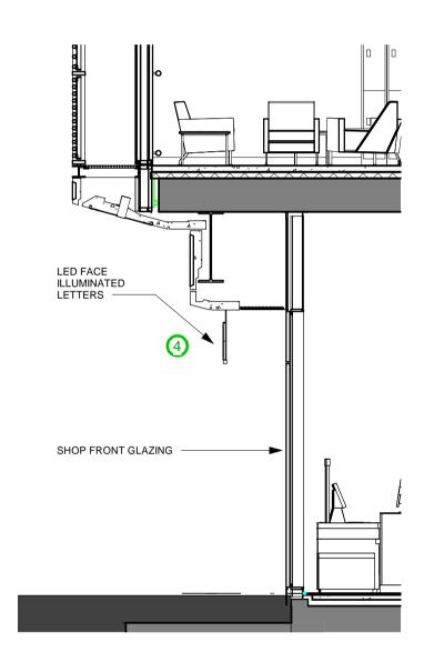
3 SIDE ELEVATION SIGNAGE SECTION
