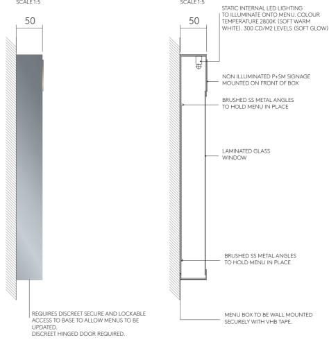
SECTION SIDE ELEVATION
