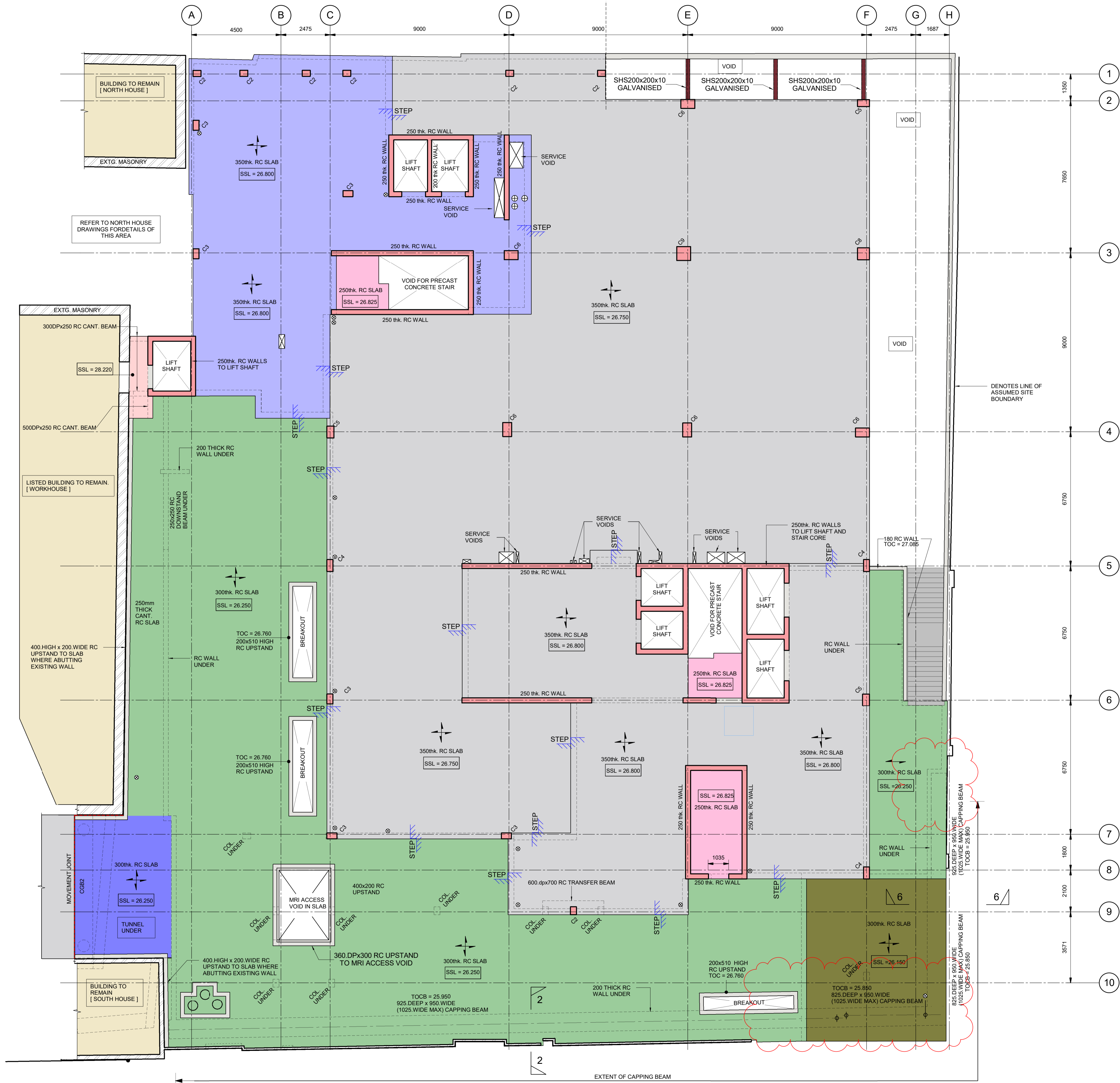
Level 0 Plan Secant Piling 1 : 100
