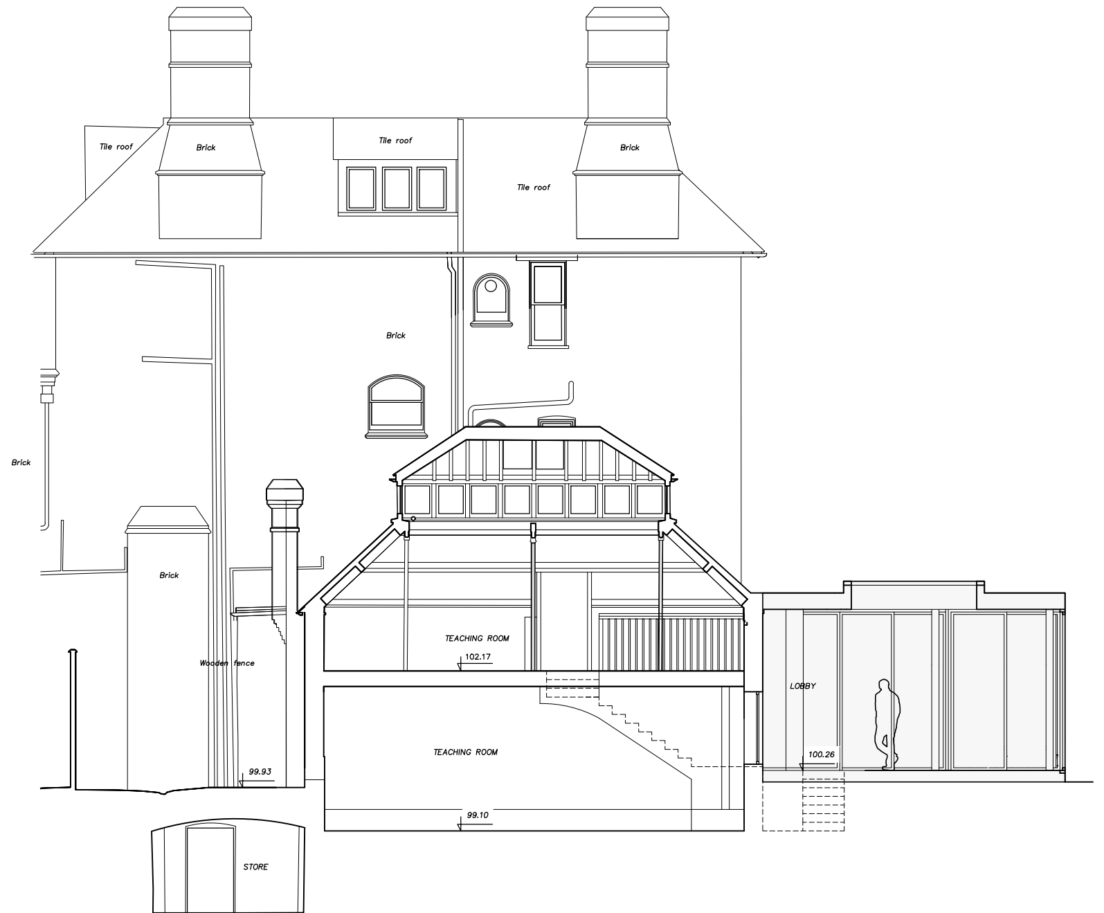
Datum 97.00 Above Site Datum SECTION EE
