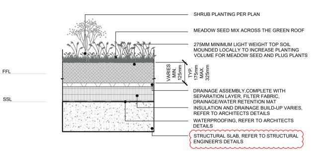
TYPICAL DETAIL - SHADED MEADOW / LOW SHRUB MIX WITH PLUG PLANTING - GREEN ROOF - SOIL PROFILE SECTION SCALE 1:25
