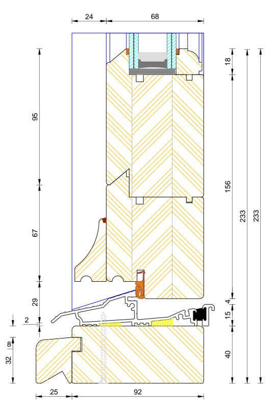
CILL EXTENSION - available options: 25mm (117mm o/a) / 47mm (139mm o/a) / 62mm (154mm o/a) / 87mm (179mm o/a) / 114mm (206mm o/a) / 125mm (217mm o/a) / 140mm (232mm o/a)
