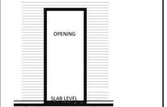
FIRESTOPS TO OVERLAP WHEREVER STEPS OCCUR TO ENSURE CONTINUOUS SEAL AND FIRE BREAK AROUND WINDOWS
