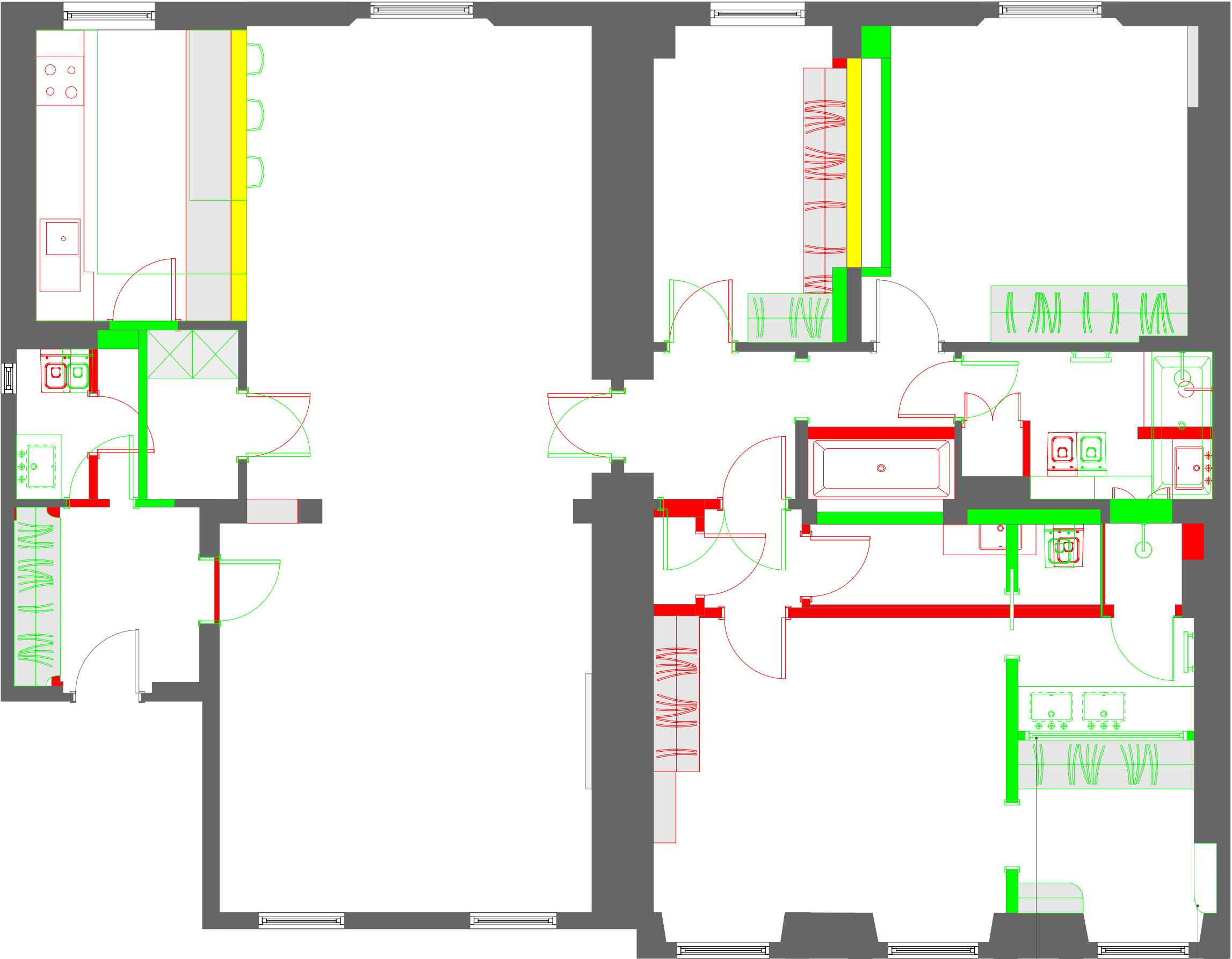
DEMOLITION PLAN Scale: 1:50
