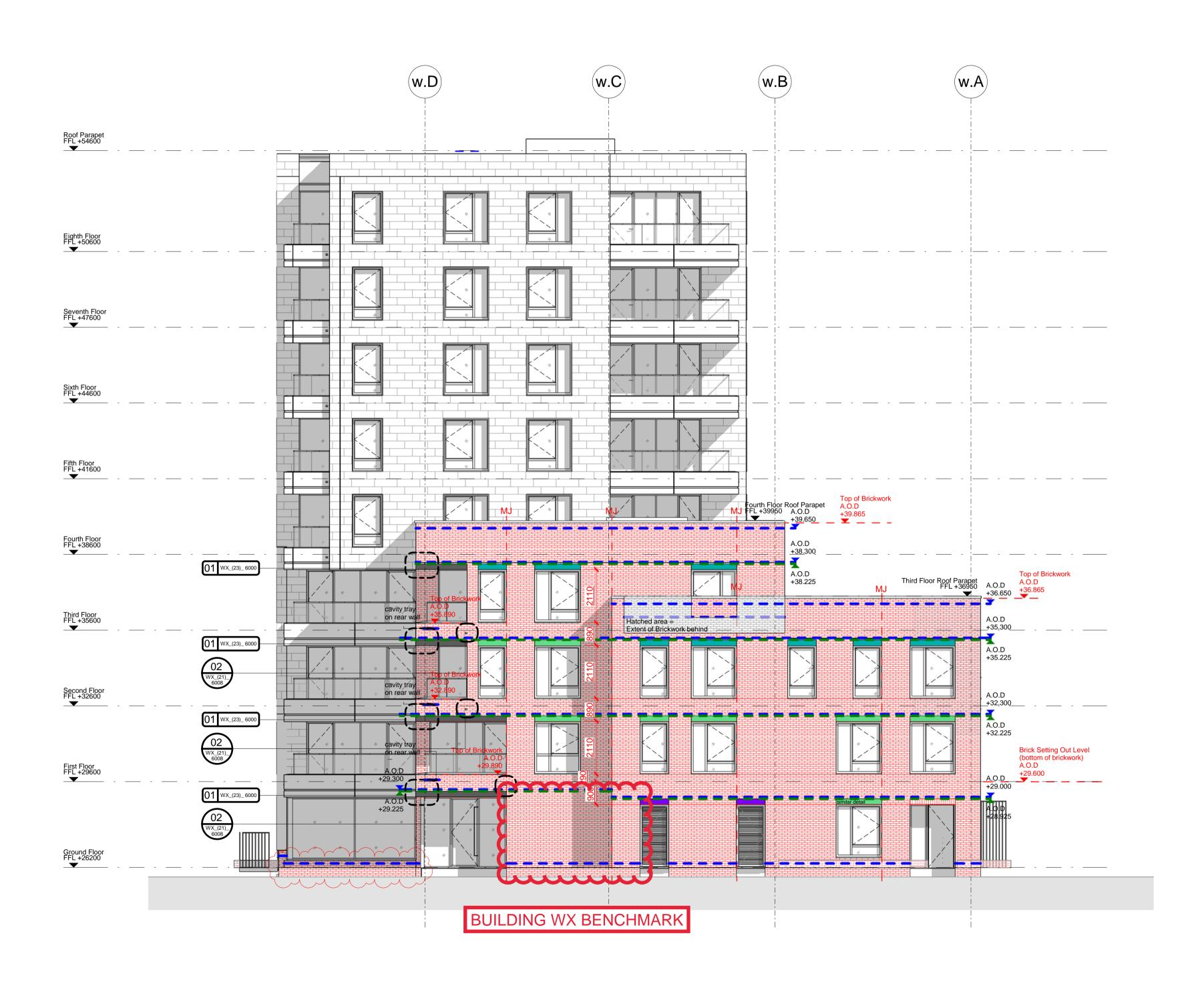
MJ - MOVEMENT JOINT IN BRICWORK
