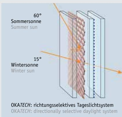
OKALUX entwickelte OKATECH mit Aluminium-Streckmetalleinlage für die Central Library in Seattle von Rem Koolhaas. Das Glas ermöglicht einen weitreichenden Einsatz von Tageslicht und erzielt mit seinen richtungsselektiven Eigenschaften einen g-Wert von 23 % bei senkrechter Einstrahlung. Die Feinmaschigkeit des Gitters erlaubt eine sehr gute Durchsicht nach außen.
