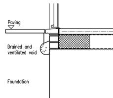
**Flush Threshold Detail**
