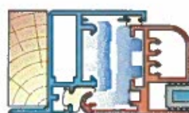
JAMB DETAIL (HINGE)
