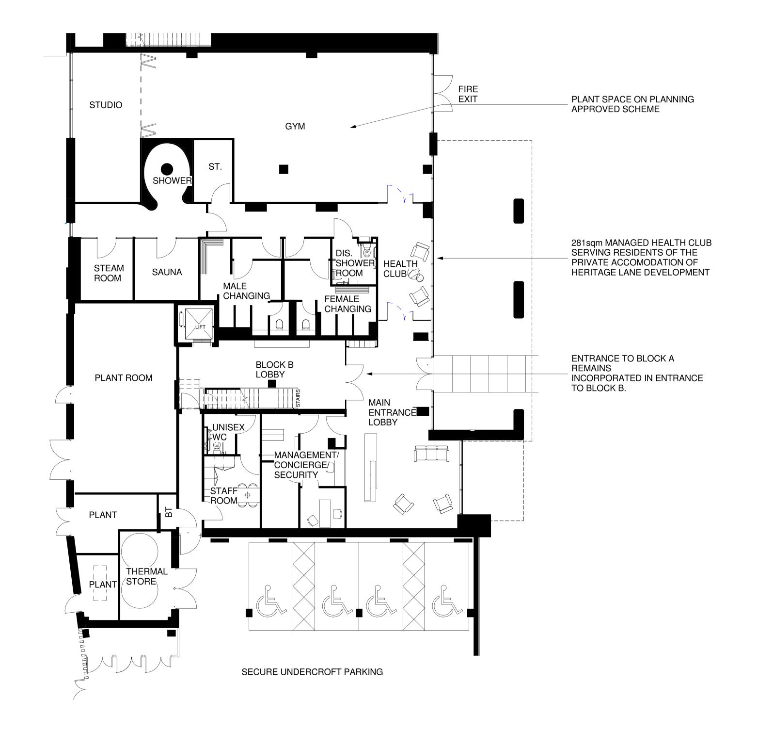
PROPOSED BLOCK B GROUND FLOOR PLAN
