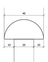
Handrailing detail Scale 1:1 / 1:2
