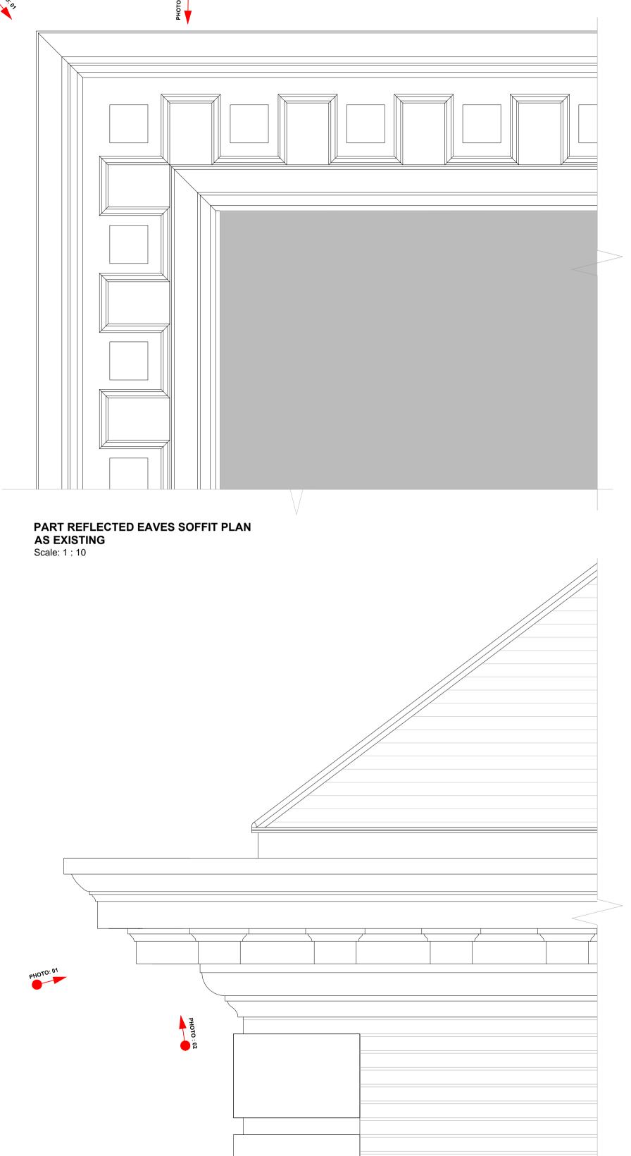
ELEVATION DETAIL AT EAVES SOFFIT LEVEL AS EXISTING
