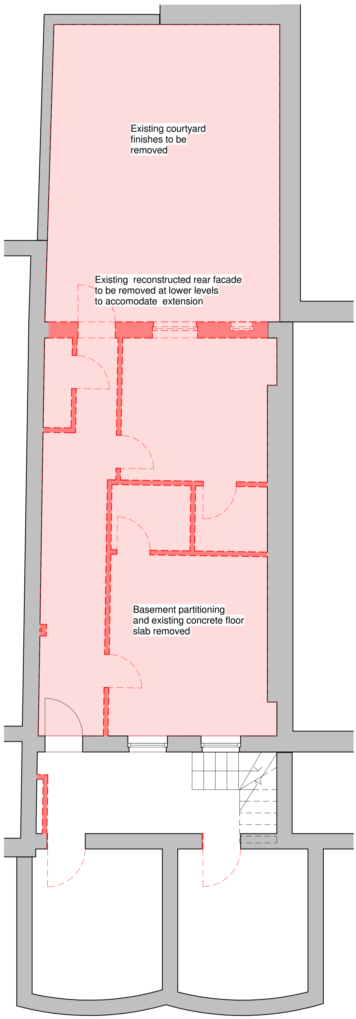
-01 Demolition Plan - Basement Level 1 : 50
