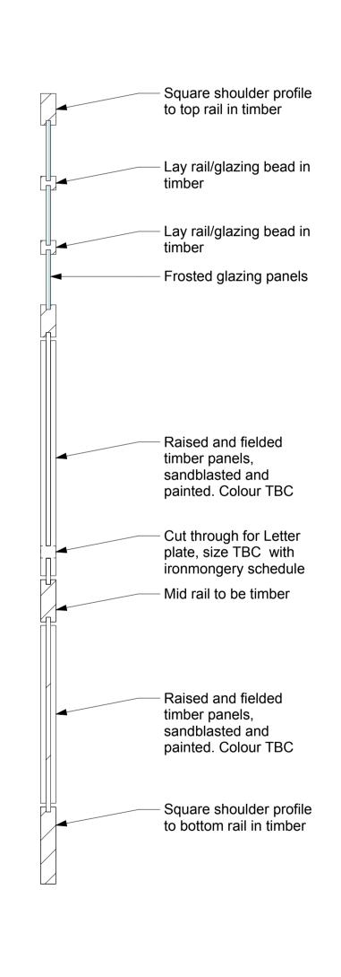
A-A FRONT DOOR SECTION - PROPOSED Scale: 1:10
