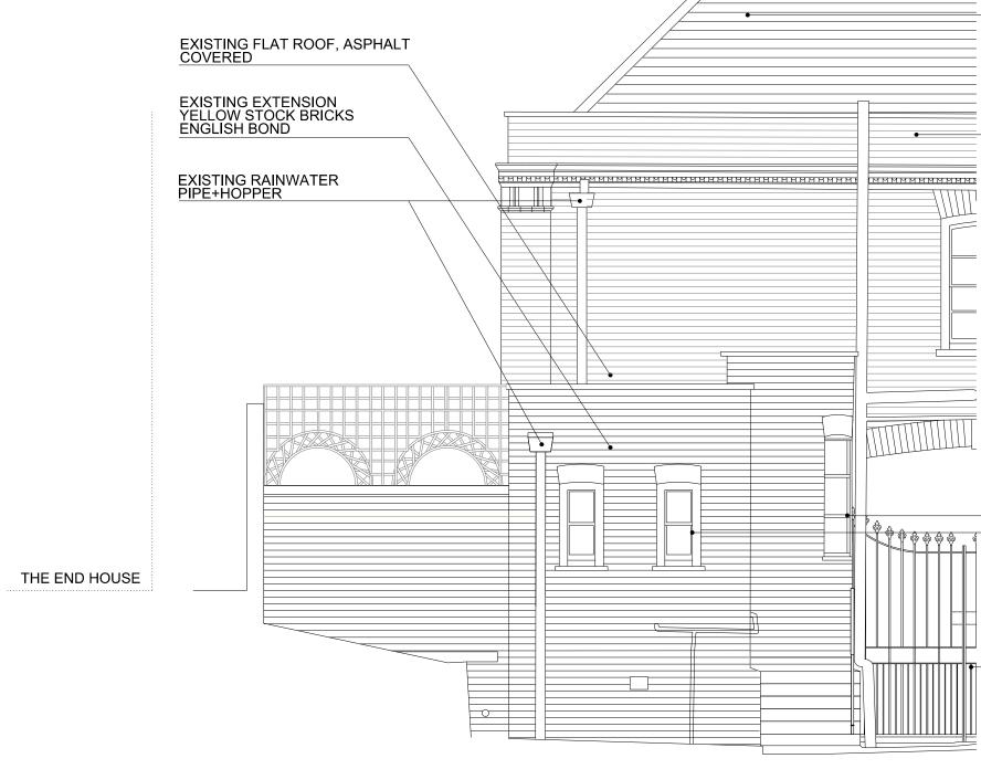
EXISTING RAINWATER PIPE+HOPPER
