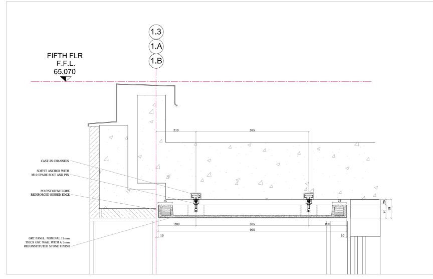
TYPICAL SECTION (BETWEEN GRIDLINES - NORTH, WEST & EAST ELEVATIONS)
