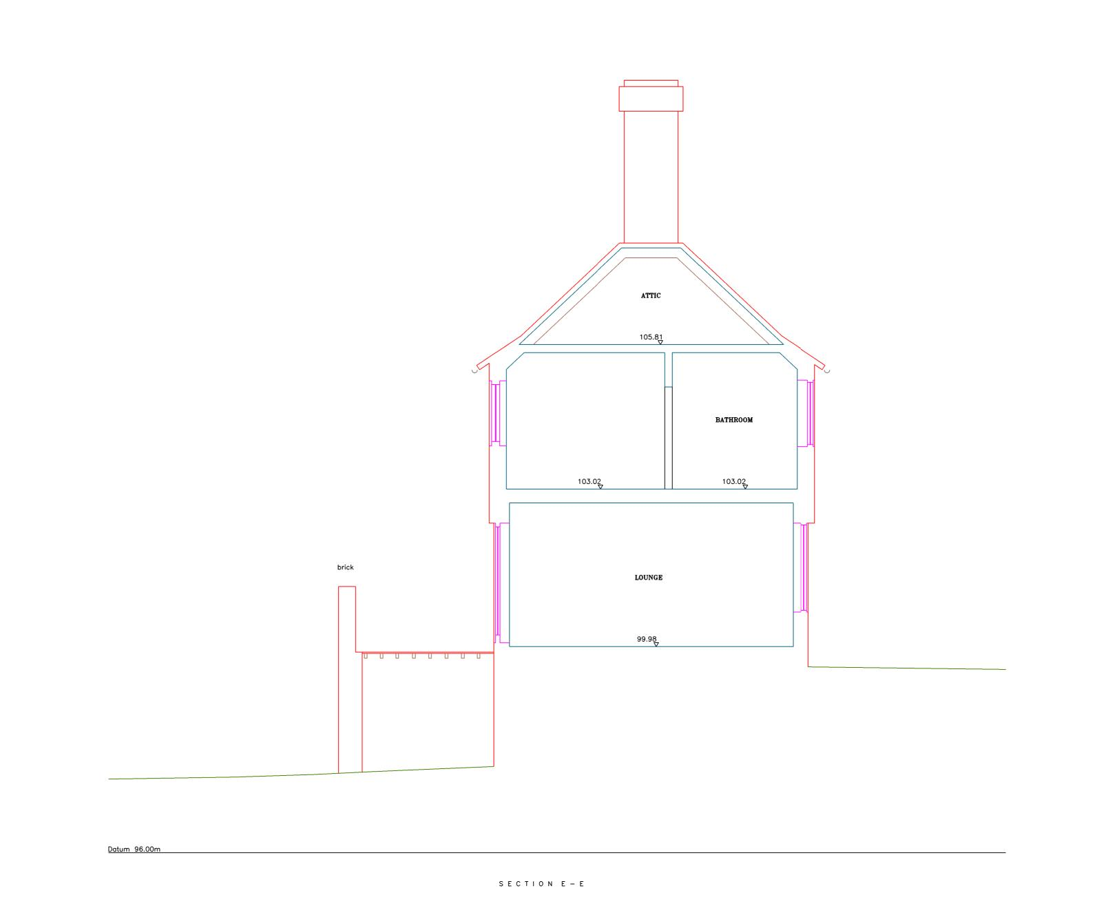
ALL LEVELS ARE IN METRES RELATED TO AN ASSUMED DATUM LOCATED ON THE GROUND FLOOR AS SHOWN (VALUE 100.00m).
