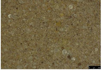
5521 Insolubles >63μm Stereomicroscope x10
