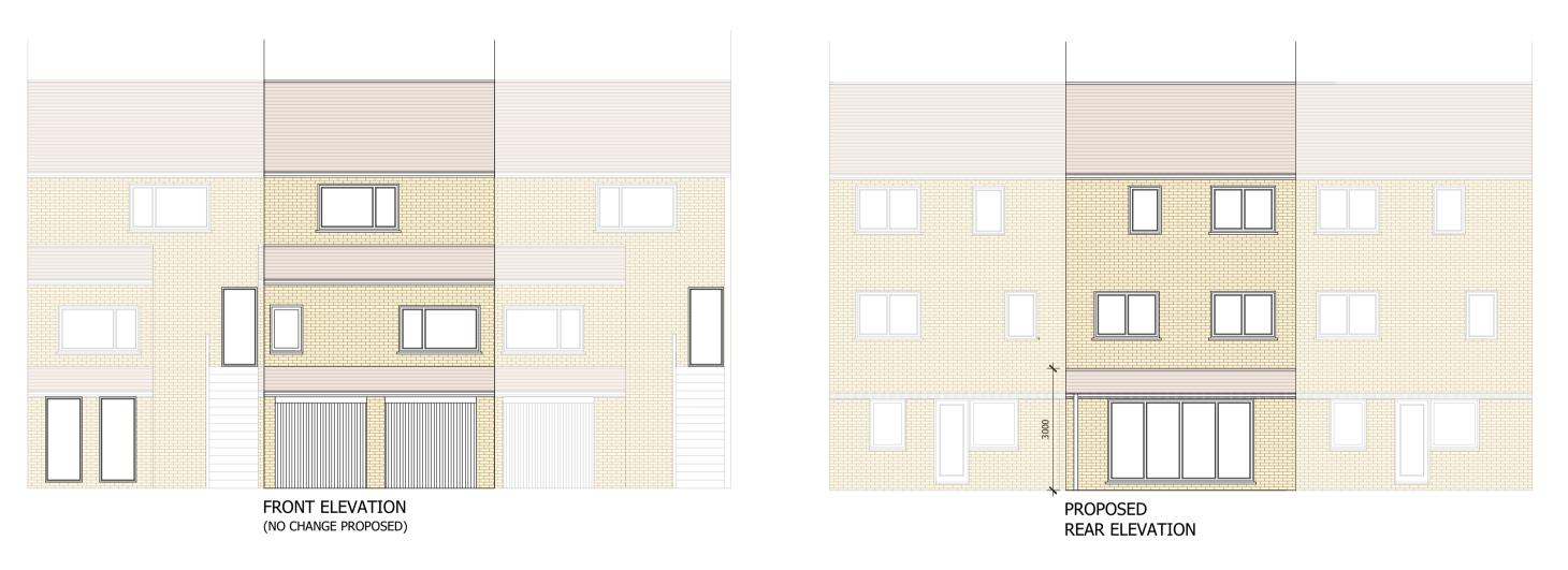
RED CLAY TILES FOR PITCHED ROOF BLACK ALUMINUM CASEMENT DOUBLE GLAZED BI-FOLD DOOR WIENERBERGER PEAK MIXED RED FACING BRICKWORK; STRETCHER BOND; WEATHER STRUCK POINTING BLACK UPVC GUTTERS AND DOWNPIPE
