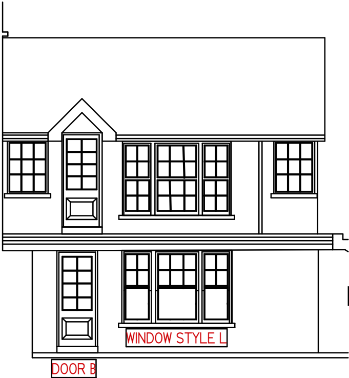
Internal Side Elevation (Patio Side)
