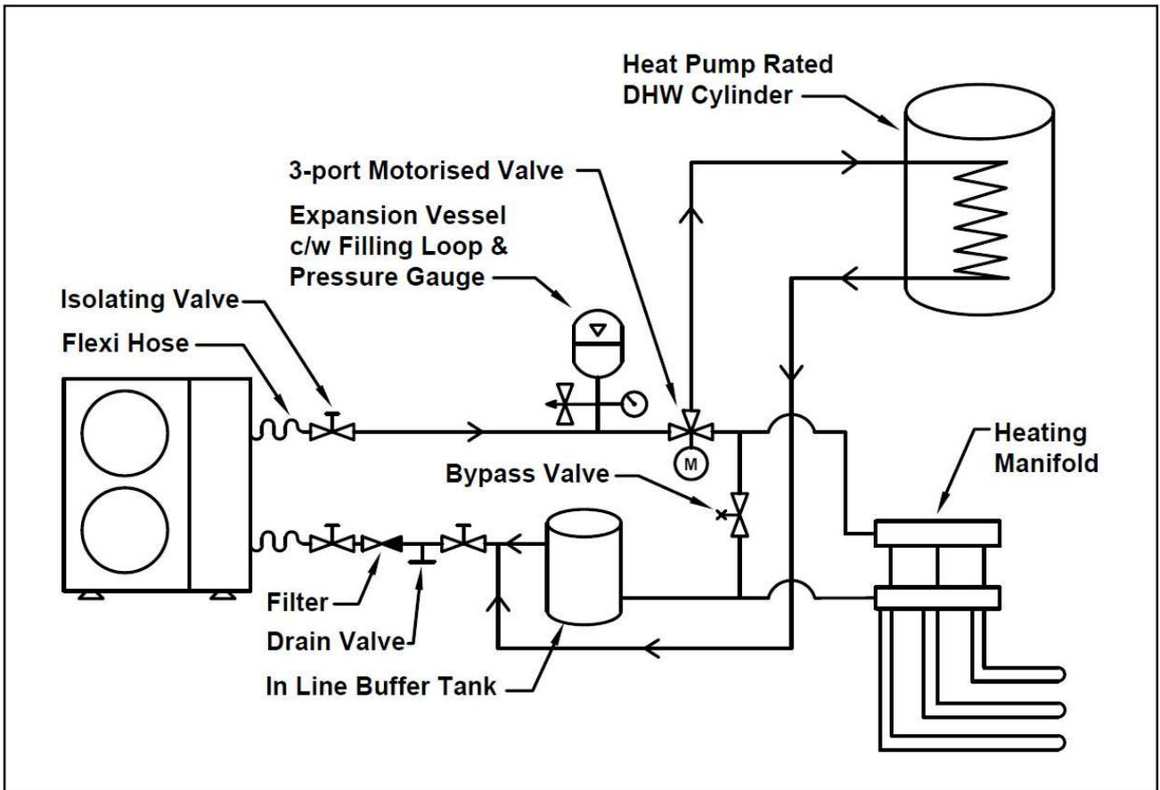
Figure 26 Heating & DHW Schematic
