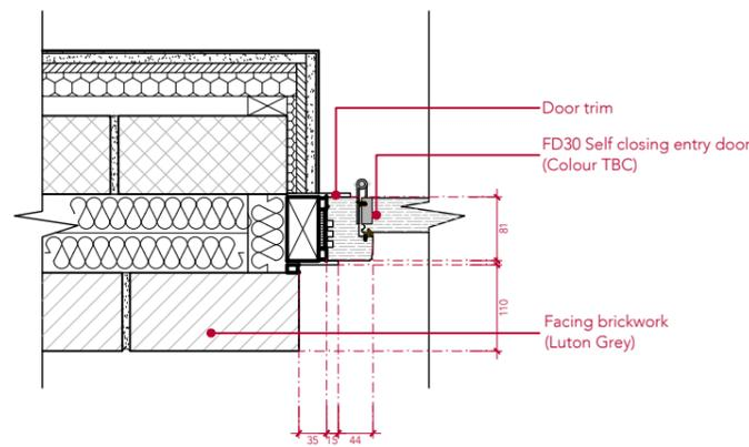
C ENTRY DOOR HINGE JAMB scale 1:10
