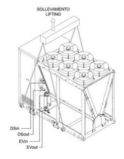
EVin Entrata acqua evaporatore Evaporator water inlet
