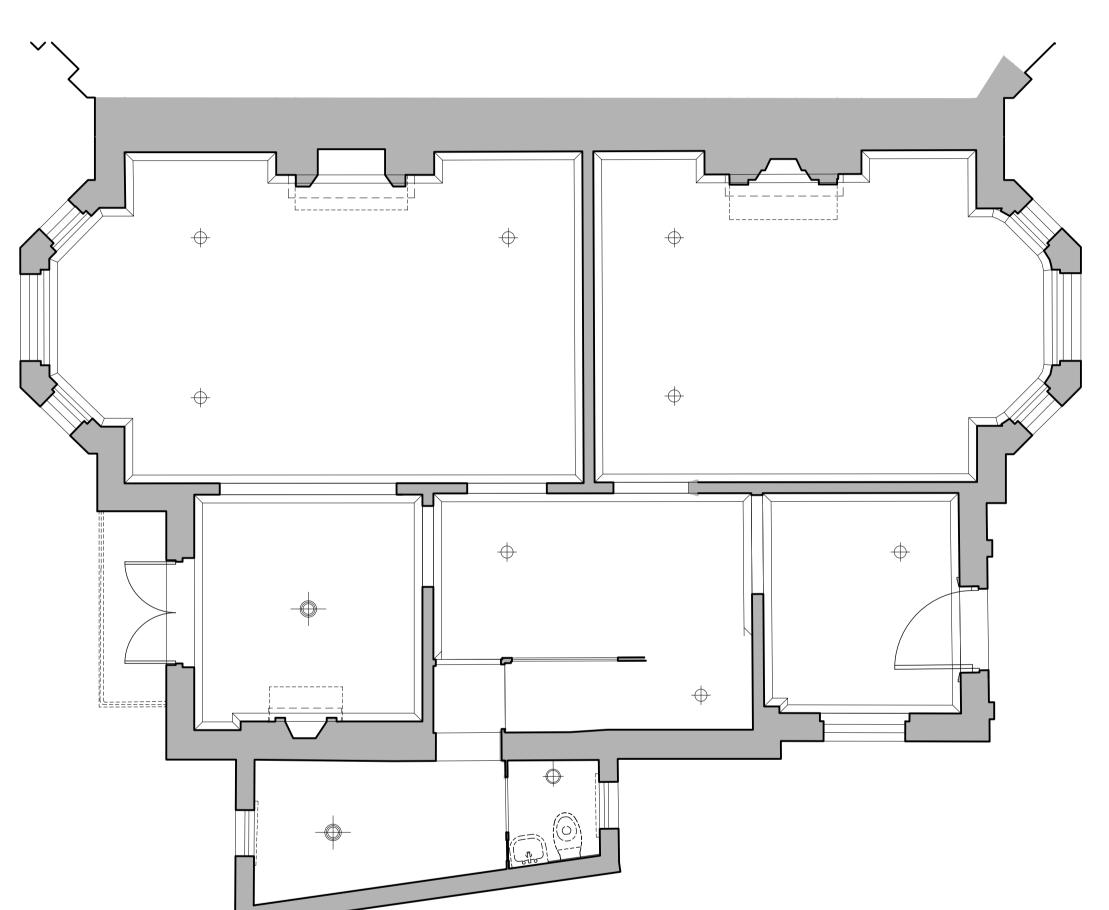
1 EXISTING LOWER GROUND FLOOR RCP LIGHTING PLAN scale 1:50
