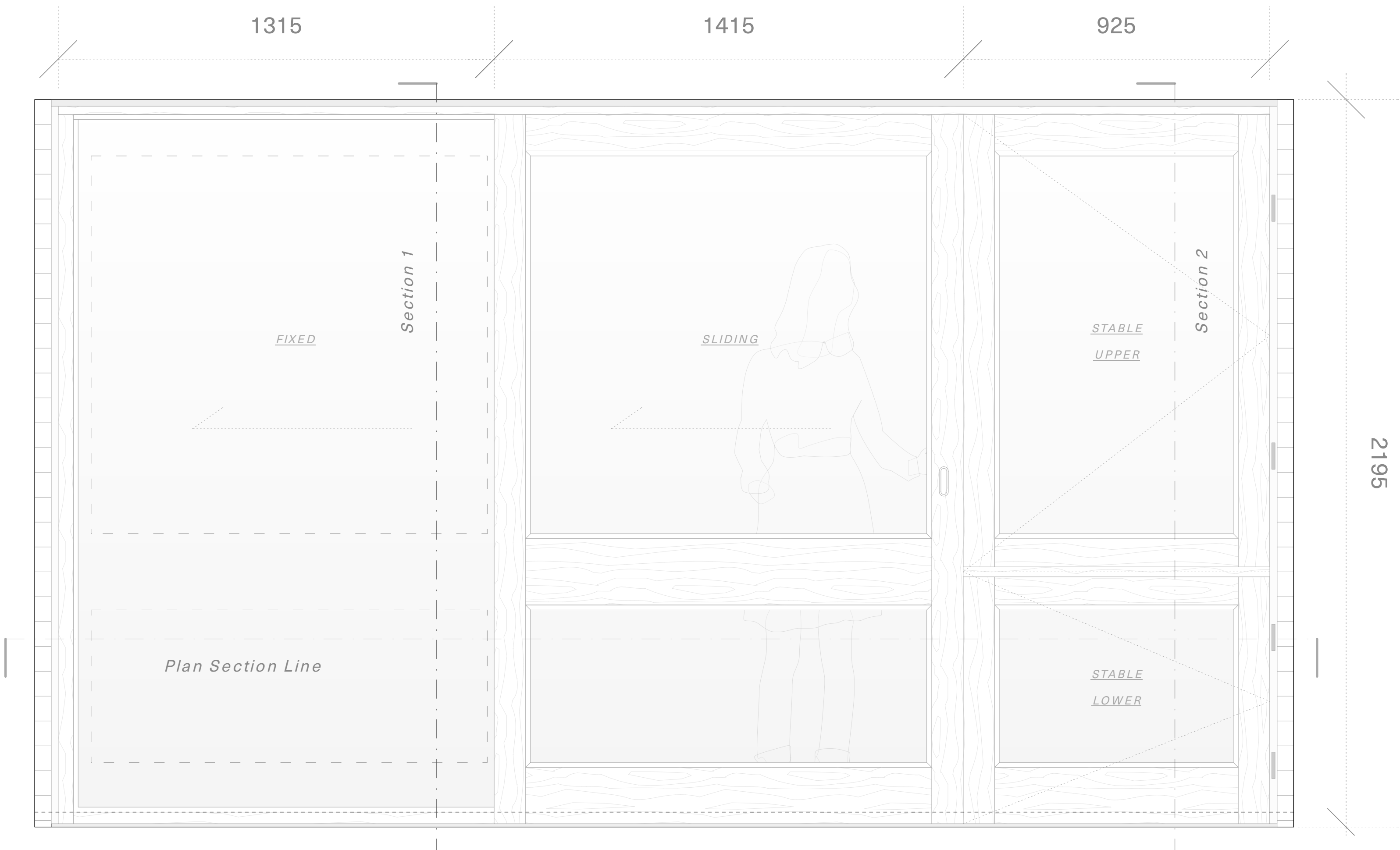
Sliding Door Assembly - Elevation 1:10
