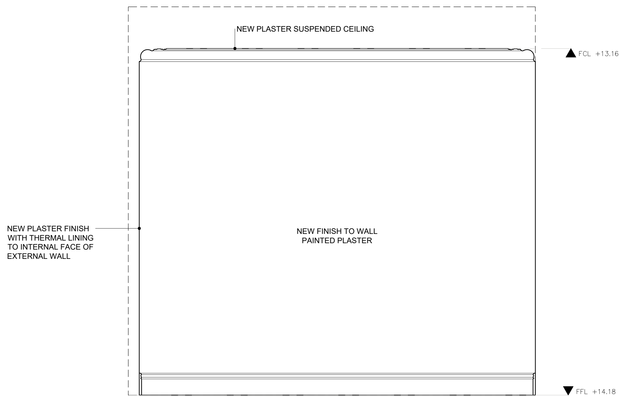
4 ELEVATION D SCALE 1:20 @A1, 1:40 @A3
