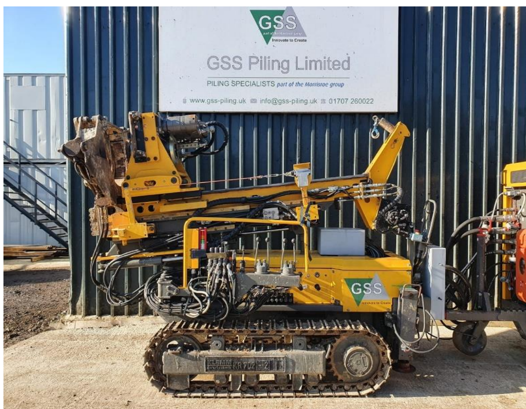
Klemm 702 mini piling rig
