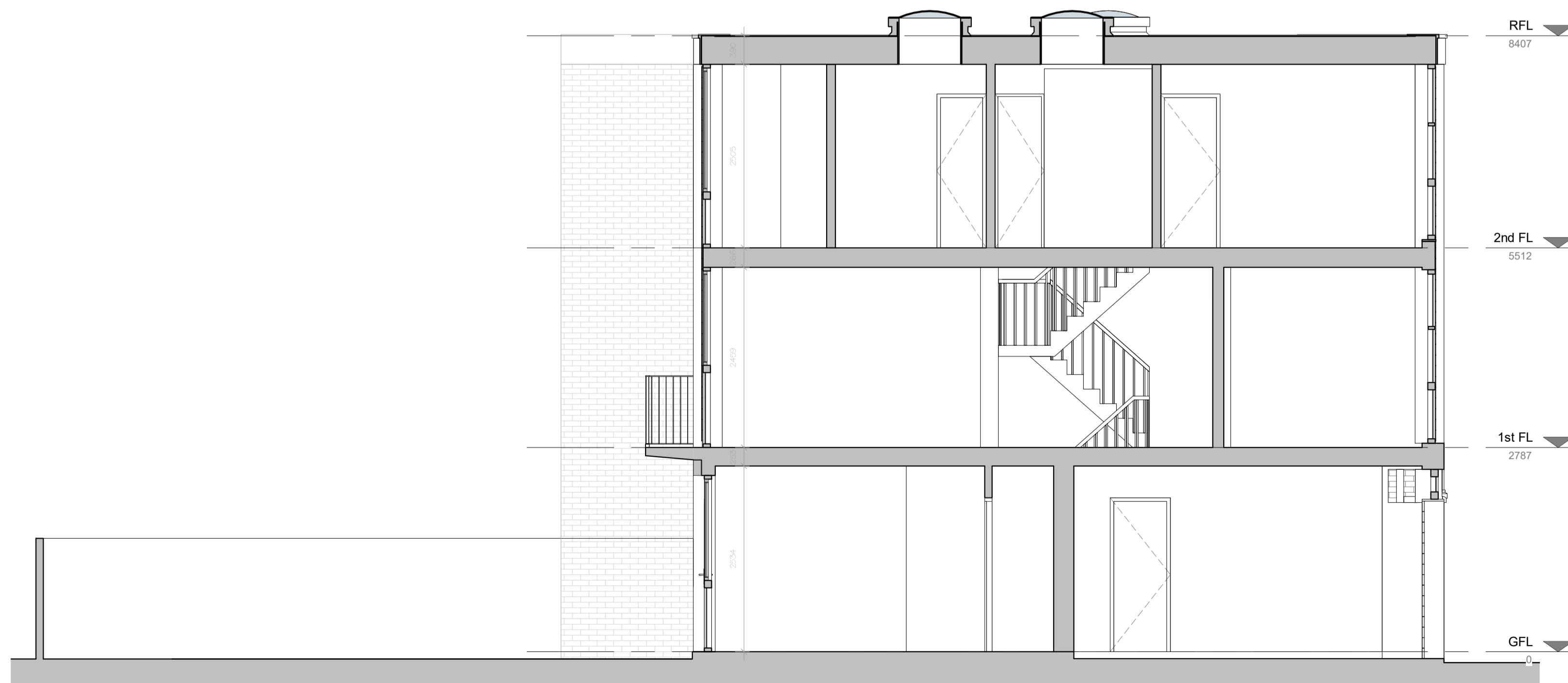
1 SECTION B-B - EXISTING SCALE: 1:50
