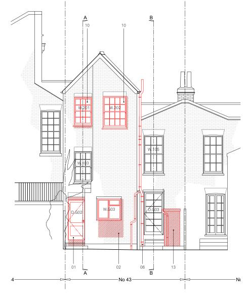
DEMOLITION FRONT ELEVATION 1:100
