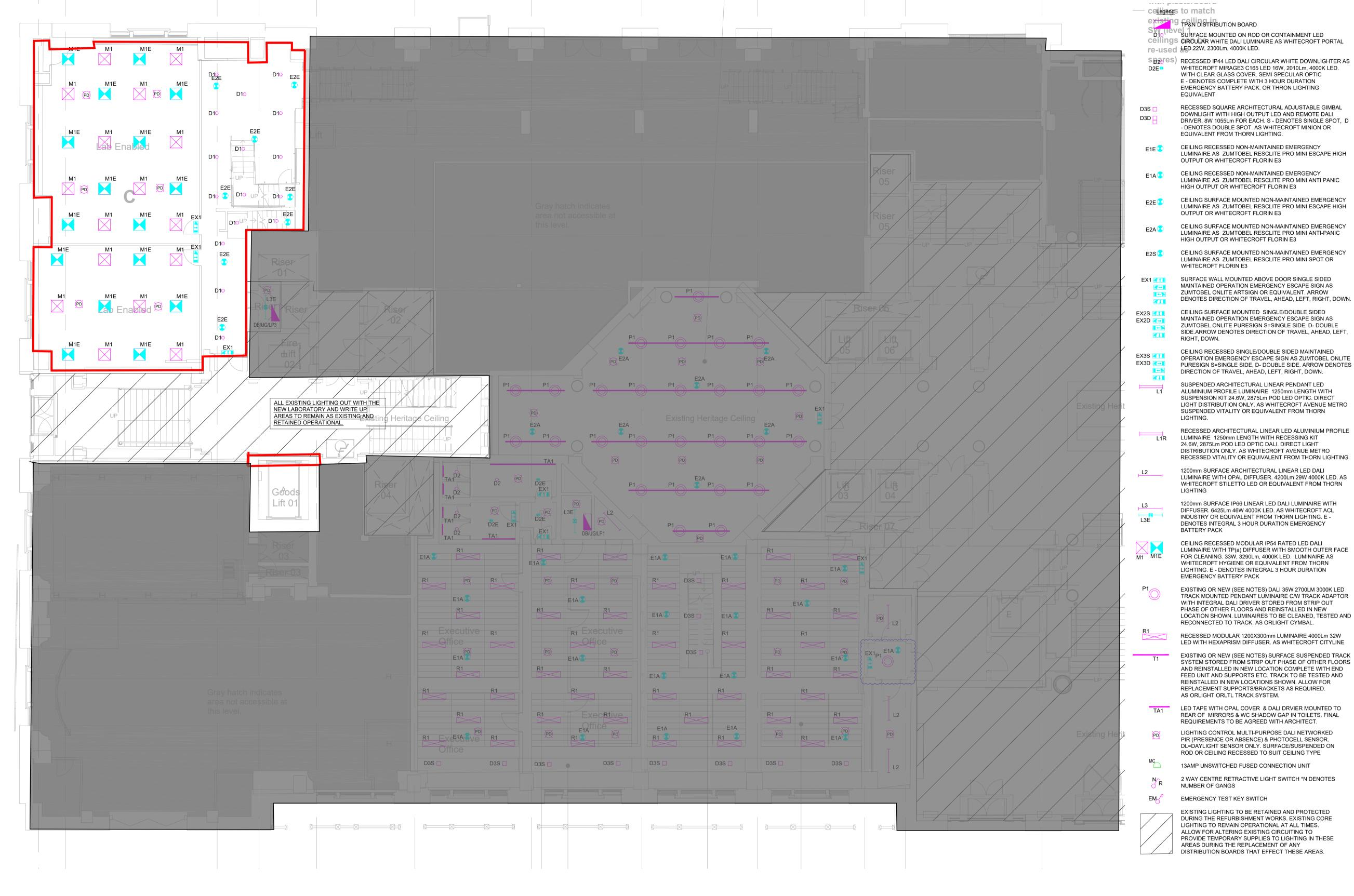
THE LIGHTING LAYOUT DRAWN SHOWS THE LIGHTING TO THE FULLY FITTED OUT LAB ENABLED SPACES. TEMPORARY SACRIFICIAL LIGHTING SHALL BE INSTALLED TO PROVIDE MINIMUM CIRCULATION ILLUMINATION AS PART OF THE SHELL WORKS.
